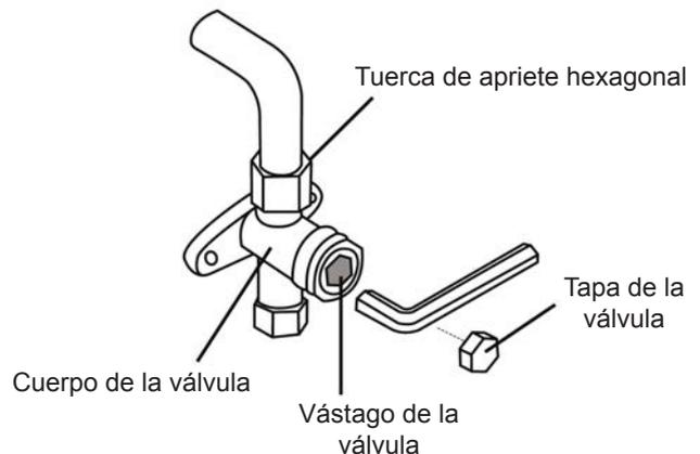
12. Utilice una llave hexagonal para abrir al máximo la válvula de alta presión y la válvula de baja presión.
