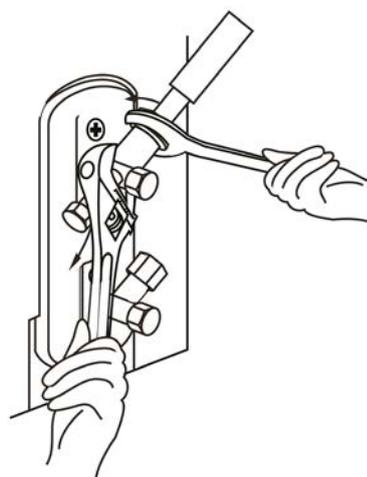
5. Mientras sujeta firmemente el cuerpo de la válvula, utilice una llave dinamométrica para apretar la tuerca abocardada de acuerdo con los valores de par correctos.
