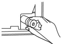
Para evitar fugas indeseadas, tapone el orificio de desagüe no utilizado con el tapón de goma incluido.
