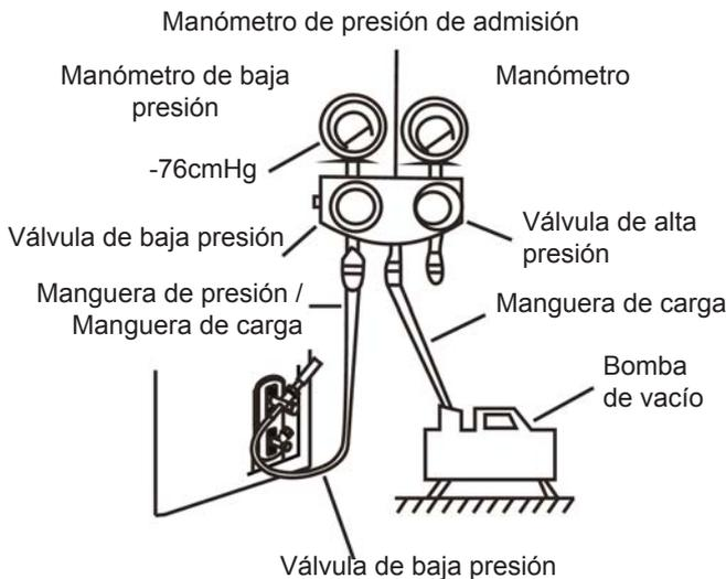
6. Cierre el lado de baja presión del manómetro y apague la bomba de vacío.
